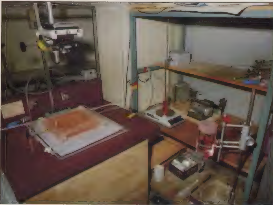
Expérience de drainage assistée par micro en milieu gravé. Acquisition : pesée, débit. Commande : prise de vue réglage/débit.
